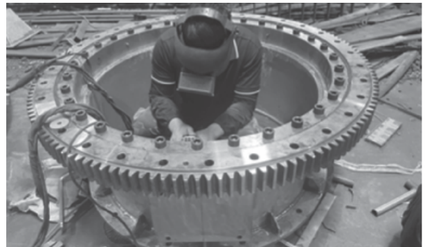
Hình 5. Chế tạo, lắp ráp bộ để quay tại nhà máy
